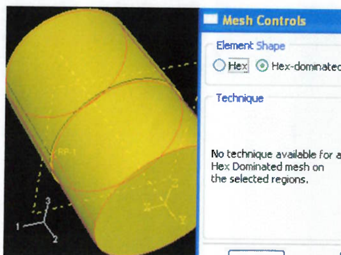
Figura 71: Não é possível gerar uma malha com elementos hexagonais neste modelo
