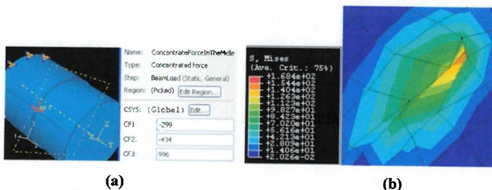
Figura 39: Material recozido no primeiro passe. (a) Força aplicada (b) Resultado
